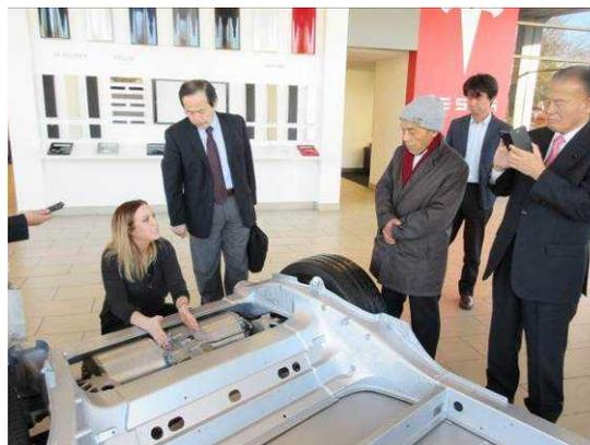
モーター式の4輪駆動で部品も少なく加速がスムーズで、0～80キロまでわずか2.5秒で加速することが可能。部品の寿命も長く、バッテリーも1本ずつの交換が可能。定期交換はブレーキパッド等のわずかなパーツのみですむ。
